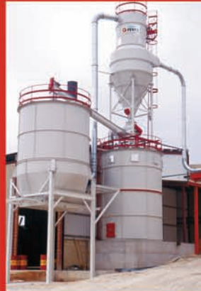
Silos de almacenamiento
