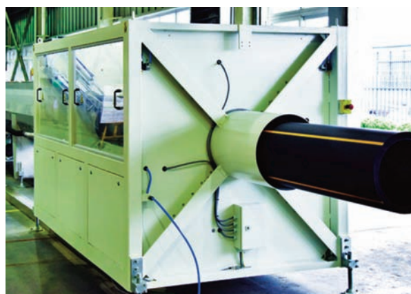
La línea de alto rendimiento solEX, con capacidad de producción de 1.200 kg/h, produjo tubo de gas de 400 mm con un cabezal helix 400 VSI-T, equipado con sistema de enfriamiento interior del tubo.
