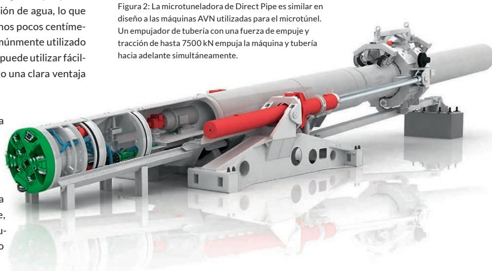
Figura 2: La microtuneladora de Direct Pipe es similar en diseño a las máquinas AVN utilizadas para el microtúnel. Un empujador de tubería con una fuerza de empuje y tracción de hasta 7500 kN empuja la máquina y tubería hacia adelante simultáneamente.
