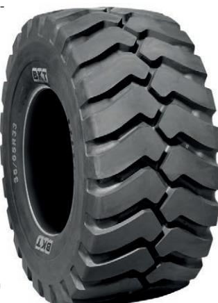
Earthmax SR 49 ha sido específicamente proyectado para las cargadoras y las excavadoras que se utilizan en las operaciones más difíciles realizadas en las minas, un ámbito en el que se requiere una excelente tracción. Gracias a la profunda banda de rodadura con categoría L4, este neumático cuenta con un ciclo de vida más amplio y asegura una larga resistencia al desgaste y a los cortes debidos a las rocas.
