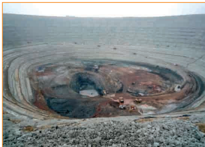
[Fig. 2].- Vista de la corta de Las Cruces en la etapa de finalización del desmonte de la Fase 2 (octubre de 2010). Obsérvese la potencia de la formación gris de margas en el talud. (Foto cortesía de CLC).
