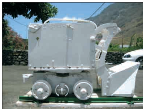
[Figura 4].- Máquina vagoneta con pala para extracción de escombros.
