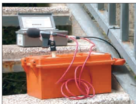
[Figura 7].- Sismógrafo White Miniseis registrando en la obra Tobira.
