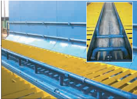
[Figs. 3 y 4] .- Boquillas laterales para lavado de ruedas, y boquillas para autolimpieza de la plataforma.
