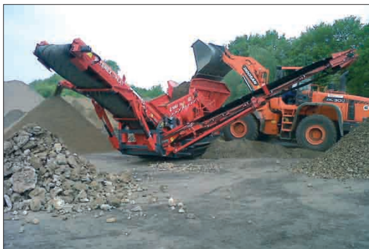
Terex Finlay ha lanzado recientemente una nueva criba móvil sobre orugas de tipo pesado y compacto para procesado de hasta 250 t/h.
