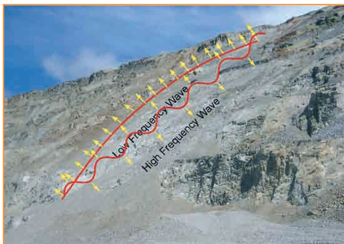
[Figura 1].- Ilustración de la resonancia de un talud por ondas de baja frecuencia (alto desplazamiento de partícula). La técnica de onda semilla incide aumentando la frecuencia y disminuyendo el desplazamiento. Imagen cortesía de Blast Dynamics.
