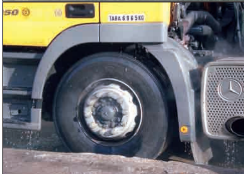
[Figuras 12 y 13].- Detalle Rueda antes de lavado (arriba); y tras el paso por el lavavueles (abajo).
