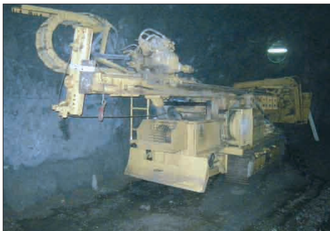
[Figura 4].- Máquina vagoneta con pala para extracción de escombros.
