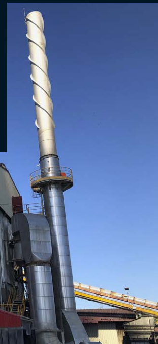
Planta de combustión del orujillo y de la poda para crear alrededor de 80.000 toneladas de biomasa.
