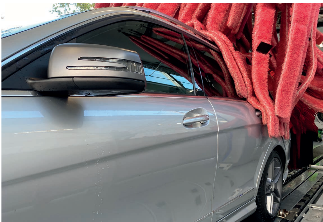
El secado también incluye una fase que se lleva a cabo con estos tiras textiles verticales, que abrazan y acarician los vehículos.
