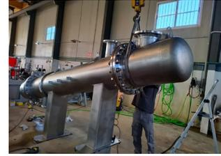
Un intercambiador de calor BEM está formado por un haz de tubos fijos dentro de una camisa. El producto fluye a través de múltiples tubos para maximizar la transferencia térmica, mientras que el fluido de servicio circula alrededor de los tubos, en la camisa exterior. Una junta de expansión permite diferencias en la expansión de los tubos y la camisa.
