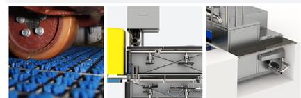
Soplado al final del proceso: elimina el exceso de agua durante la salida del transpalet, para evitar el agua en el suelo de la sala. Instalación con foso para trabajar en un único nivel.
