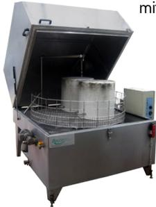
Las máquinas LK-R de Bautermic, S.A, permiten lavar, desengrasar y enjuagar piezas de diferentes dimensiones y con un alto grado de suciedad.
