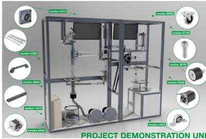
Para hacer realidad el proyecto, norelem suministró diferentes componentes como, por ejemplo, rodillos guía con un sistema de bloqueo y robustas empuñaduras de tubo que se instalaron para facilitar el transporte y la colocación de la máquina. También se emplearon tornillos de cabeza plana y otros componentes normalizados para montar el reactor de lecho fluidizado.
