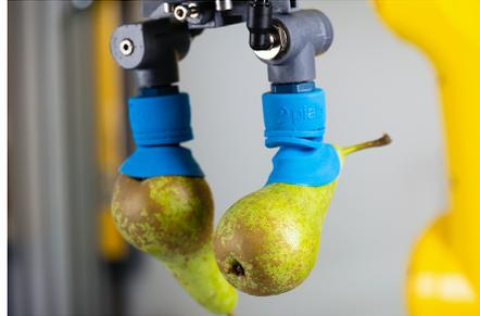
fruta igual de bien que su parte más ancha. Los fuelles flexibles permiten que los labios se adapten, se realineen y se sellen con firmeza sobre el producto, incluso si la ventosa desciende fuera del eje. La ventosa FCX50 cumple las normativas FDA 21 CFR 177.2600, UE 1935/2004 y UE 2023/2006.
