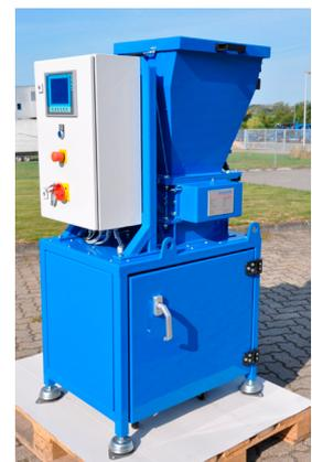
El material pasa al mecanismo de corte, que consta de dos ejes con cuchillas de acero girando de forma asincrónica.
