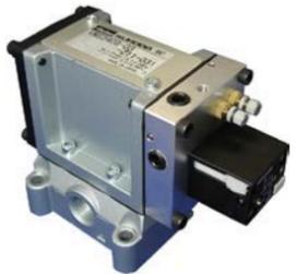
El componente central es una válvula de conmutación que transforma el soplado de aire continuo en soplado de aire por pulsos sin necesidad de ningún otro control externo. De esta manera, crea aire que se sopla en una serie de pulsos de alta velocidad intermitentes; lo cual significa menos ciclos de recarga de tanques.
