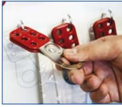
uso del bloqueo/etiquetado en línea con los principios de la producción ajustada. Permite mostrar dispositivos de bloqueo/etiquetado, candados y documentos, de forma que quedan claramente visibles y los empleados puedan seleccionarlos fácilmente, y además hace posible la comunicación de permisos de trabajo, proyectos de mantenimiento o aislamientos de bloqueo/etiquetado.
