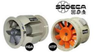
La serie HTP posee un envolvente tubular en chapa de acero de gran espesor, soporte de motor soldado al envolvente, directrices de alto rendimiento aerodinámico para ganar presión, y una protección superficial óptima gracias al uso de acero de alta calidad. Su hélice de alto rendimiento está fabricada con fundición de aluminio. El sentido del aire es hélice-motor y cuenta con una conexión eléctrica mediante caja de bornes externa.
