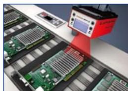
BLOB es la abreviación de Grandes Objetos Binarios („Binary Large Object“) y caracteriza una forma geométrica compuesta por un conjunto de puntos de la imagen con una intensidad de luz dentro de los límites previamente definidos. A través del ajuste de las características de BLOB se pueden detectar y diferenciar objetos o grupos de objetos según sus características geométricas, también en aplicaciones en las cuales otros sistemas habían dado resultados erróneos.
