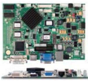
Digital View, empresa representada en España por Anatron, S.A., ha anunciado su nuevo controlador de interface LCD 'mult-sync' HX-1920, que ofrece soporte real de 10 bit (mil millones de colores) para LCD TFT de alta definición y gran formato con resolución WUXGA (1920 x 1200) en entornos adversos.
