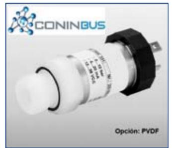
Coninbus presenta su transmisor de presión/nivel plástico. Este transmisor de presión industrial está especialmente diseñado para fluidos agresivos, pudiendo trabajar en rangos de 1 + 400 Bar, con una precisión del 0,5%. Las partes en contacto con el fluido están realizadas en PVDF.
