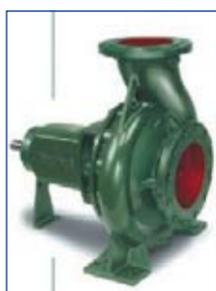
versión estándar), para responder con eficacia a las exigencias del sector industrial; Doble anillo de desgaste para garantizar la regeneración del producto en caso de deterioro. Los cojinetes, ampliamente dimensionados, están lubricados con grasa permanentemente.
