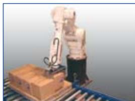
La principal novedad de este nuevo concepto es la integración de todos los elementos de la célula sobre una referencia común, por lo que su montaje es muy sencillo, pudiéndose incluso realizar por el propio cliente final sin la intervención de personal técnico de Inser Robótica.
