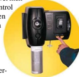
El ToxiRAE 3 presenta una cubierta frontal de acero inoxidable para protegerse de los entornos extremos y está disponible en tres modelos: sulfuro de hidrógeno (H<sub>2</sub>S) y alto y bajo rango de monóxido de carbono (CO<sub>2</sub>). Estos monitores de gases tóxicos llevan certificados de seguridad de USA, Canadá, la UE e IECEX, para su uso en entornos peligrosos en los mercados de producción de petróleo, gas, acero, refinerías y personal de primera intervención.
