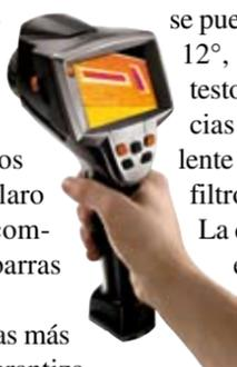
El registro incluso de las diferencias más pequeñas de temperatura queda garantizado por el uso de una óptica de germanio de elevada calidad en la que incide de forma perfecta la radiación IR. La electrónica desarrollada especialmente para la óptima utilización del detector y la resolución térmica de < .01 °C, es decir, la exactitud relativa entre píxels (NETD), proporciona una imagen de alta definición y calidad. El objetivo estándar de 32°
