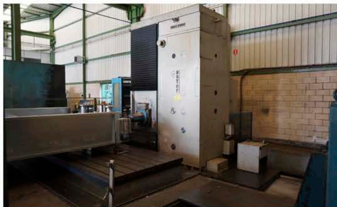
FRESADORA COLUMNA MÓVIL ZAYER 30 KC-5000. Año 2003 CNC HEIDENHAIN TNC 430. Recorridos (X/Y/Z): 5.000/1.250/2.000 mm. Superficie Mesa 5.000x2.000 mm. Cabezal Automático 45° 0.001º/0.001º Cabezal Salida Directa. Evacuador Viruta. Cargador 30 Herr. Refrig. Interna
