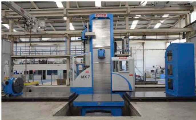
FRESADORA COLUMNA MÓVIL JUARISTI MX7 10.000. Año 2004 CNC Siemens 840D. Recorridos (X/Y/Z): 10.000/4.000/1.500 mm. Evacuador Viruta Long. Refrigeración a través de Hta. 20 BAR. Cabezal Giro Automático Birrotativo 4000 rpm. 1º/1º.
