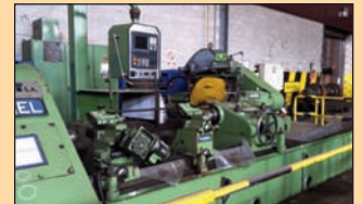
RECTIFICADORA para rodillos FARRELL CNC SIEMENS, 4 metros
