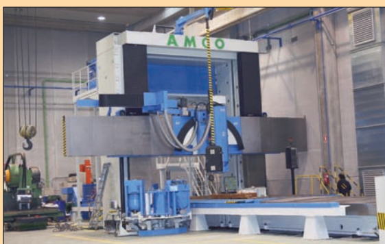
FRESADORA PUENTE AMCO-SACEM FPF-4500, 5 Ejes controlados, CNC Heidenhain 530i X: 10.000 mm. Y: 5.900 mm. Z: 1.200 mm. W: 3.000 mm. Cambio automático de cabezal
