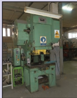
Prensa excéntrica con embrague BELT modelo BREN-80 de 80 tons
