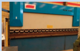
Plegadora ERMAKSAN Mod. PCN4160. Máquina de 4000 x 160 Tn. con cuello de cisne de 400 mm. distancia entre montantes de 3550 mm. Marcado CE.
