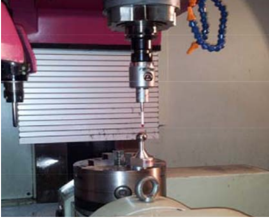
Fig. 1. Instrumentación para la calibración automática: Esfera calibrada y palpador.
