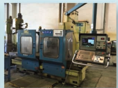
Fresadora de bancada fija CORREA CF 22/20 cnc HEIDENHAIN TNC 426 . Recorridos 2000x800x800 mm
