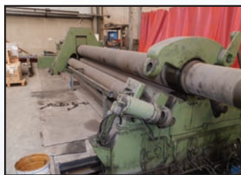
Cilindro WILHELMSBURGER de 6500 x 12 mm (mecánico con amarre hidráulico)
