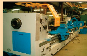
TORNO GURUTZPE SUPER-AT 6.000 mm. e/p, Ø s/bancada 1.200 mm.
