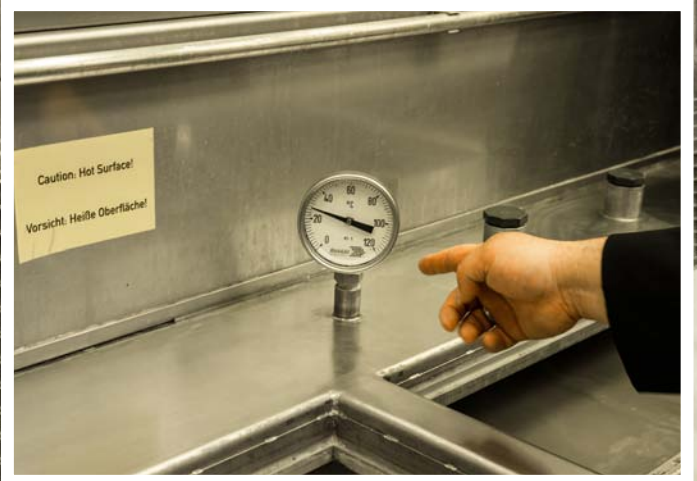
La temperatura del baño de desengrase no alcanza los 30 °C. Foto: Henkel AG & Co. KGaA / Olaf Mündelein.
