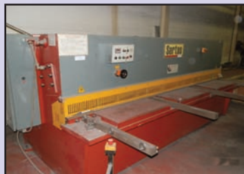
Cizalla hidráulica SERTAS de 3000 x 6 mm del año 2007
