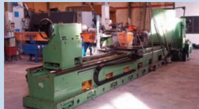
Torno Guturutzpe SUPER BT visualizado de distancia entre puntos de 6000 y volteo sobre bancada de 1600. Equipado con dos platos, Ø 1500 y Ø 500, y dos lunetas. Máquina en excelente estado. Marcado CE.
