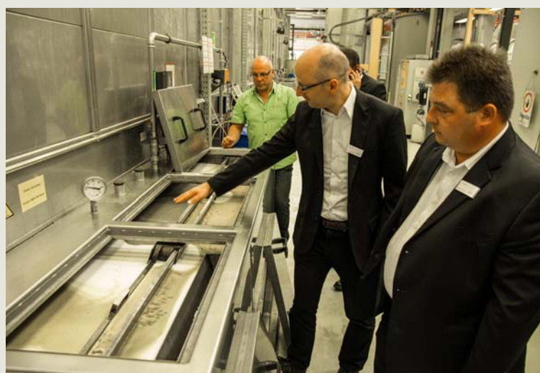
Andreas Maslowski y Marko Poleschak comprueban la temperatura y la calidad del baño de desengrase. Foto: Henkel AG & Co. KGaA / Olaf Mündelein.
