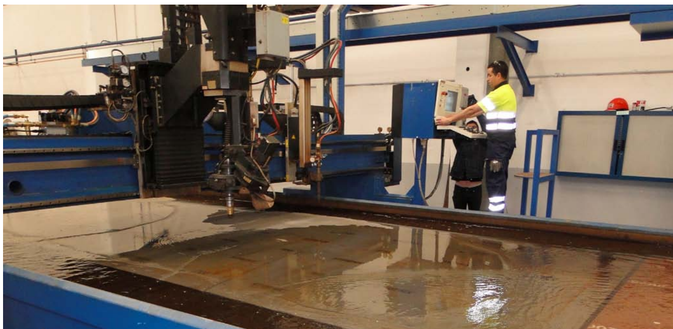
Máquina de oxiacorte y plasma trabajando sobre agua.
