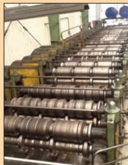
LINEA PERFILADO CHAPA TRAPEZOIDAL TACI-ARRASATE 18 EJES 1.250 MM.
