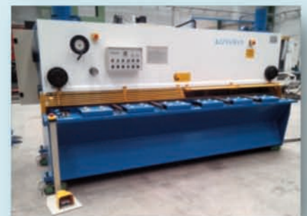
Cizalla KLINSMAN RPG3106 de 3100 x6 mm. Con tope motorizado.
