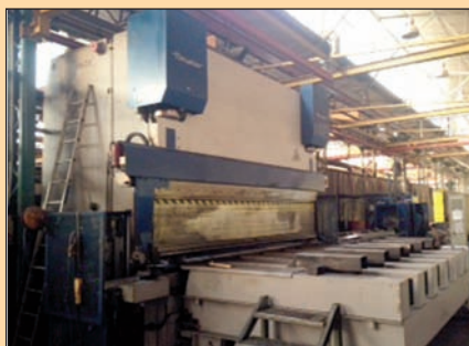
PLEGADORA BEYELER CNC 4300x500 TM Posicionador y Matriz programable
