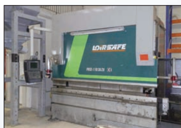
Plegadora PHSE 170-30 de 3000 mm x 170 tons del año 2004. CNC 5 ejes. Amarre hidráulico superior e inferior con mesa de bombeo
