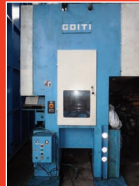
Prensa excéntrica rápida GOITI + alimentador, 40 Tn., de 100 a 600 g.p.m
