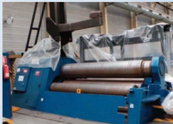
Cilindro DAVI de cuatro rodillos de 3050 x 52/44 equipado con soporte central y mesa de alimentación lateral. Marcado CE.
