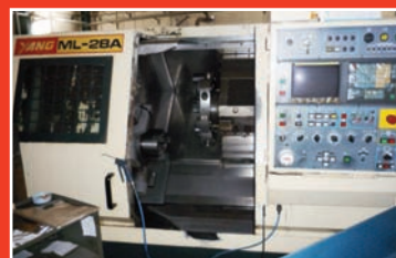
Torno CNC YANG, ML-28-A, paso de barra 52 mm., control FANUC O-T
