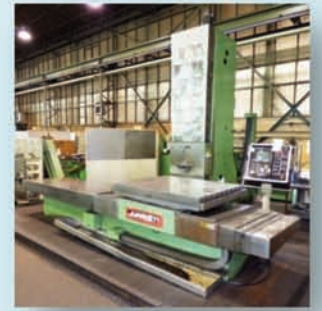
Mandradora JUARISTI TS-1 5 ejes cnc HEIDENHAIN TNC 355 . Recorridos 3000x2000x1500 mm. Ø husillo 125 mm
