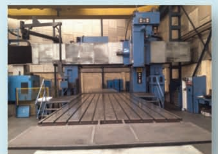
Fresadora de puente DYE FPF-N/C cnc FIDIA . Recorridos 7500x4000x1700 mm. Equipada con cargador+ 2 cabezales
