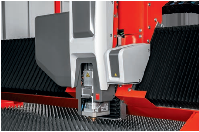
La nueva cabeza de corte amplía el espectro de rendimiento de ByStar. Éste adapta con precisión el rayo láser para que coincida con el grosor del material.
