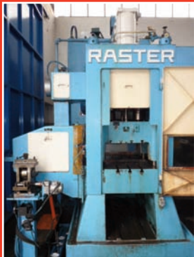
Prensa rápida RASTER + alimentador + recogedor, 60 Tn., de 160 a 800 g.p.m
