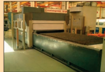
CORTE POR LÁSER SALVAGNINI L1-3015 2 PALETS LÁSER ROFIN SINAR DC 015
