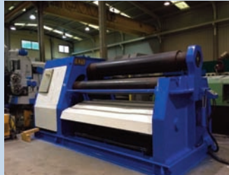
Cilindro hidráulico de ocasión marca DAVI Modelo MCB 3045 de cuatro rodillos de 3050 mm de longitud , precurvado 32 y curvado 40. Marcado CE.
