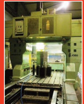
Centro de fresado vertical JOBS, modelo Jomach 243, con CNC Fidia M30
