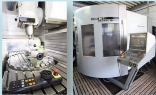
Centro DECKEL MAHO DMU 80 T 12000 RPM cnc HEIDENHAIN TNC 430, 5 EJES . Cargador 32 hmtas. Recorridos 880x630x630 mm. Mesa rotativa Ø 700 mm.
