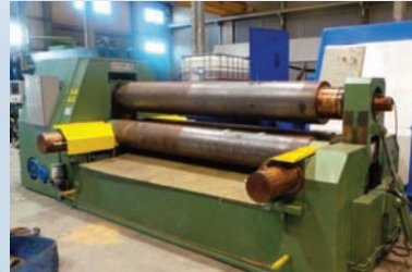
Cilindro hidráulico SERTOM Mod. EMO 3030 de geometría variable de 3050 x 40/30 mm. Marcado CE.
