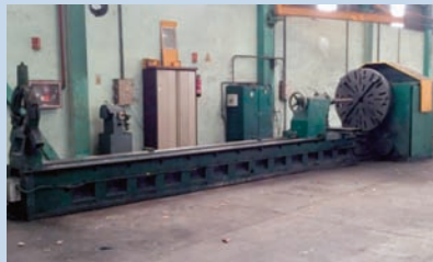
Torno ECHEA de bancada plana de 7.000 mm entre puntos. Con plato de 1400 mm. Marcado CE.
