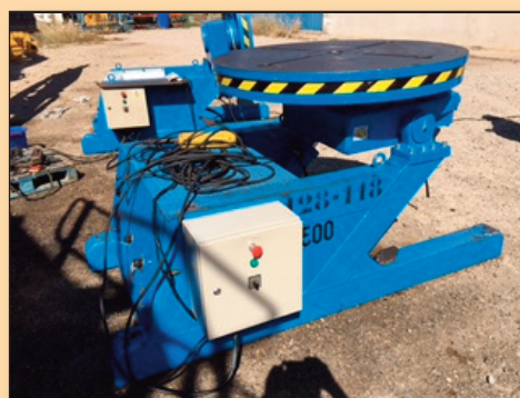
POSICIONADOR DE SOLDADURA CALVERA RC-2500 Carga 2.500 kg. Ø PLATO 1.450 mm.
