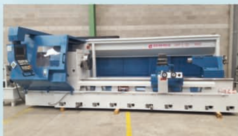
Torno GEMINIS GHT5 G2 - 1000 x 4000 cnc SIEMENS 810 D Torreta PARAT RD4 , extractor de virutas. Año 2009.
