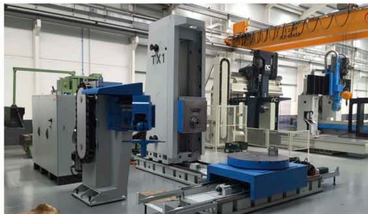
MANDRIDORA JUARISTI TX15 Año 2007. HEIDENHAIN TNC 530 Recorridos (X/Y/W): 2.000/2.000 /600mm. Evacuador Viruta Long. Refrigeración Interna. Cargador de 30 Herramientas. Mesa Rotatoria 1200 mm. de diámetro
