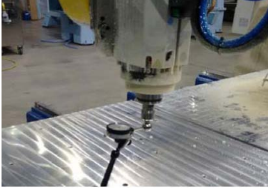
Fig. 4. Proceso de comprobación de los parámetros de la cinemática.
