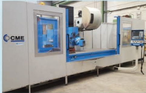
Fresadora CME FS-4 cnc FAGOR 8055T . Recorridos 3000x1200x1000 mm. Equipada con 4º eje divisor Ø 600 mm.
