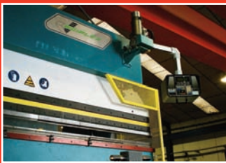
Plegadora hidráulica ACIPLEX, 3.000 x 65 Tn., cnc a 2 ejes
