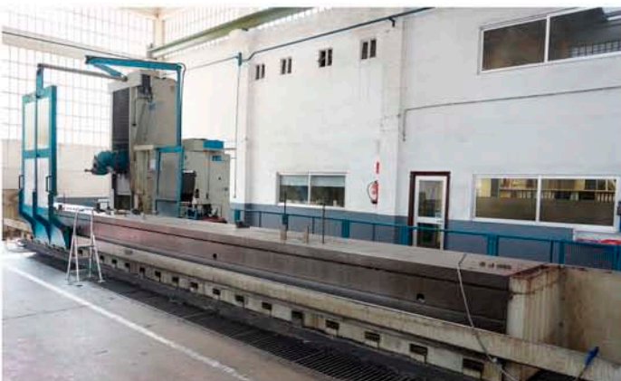
FRESADORA COLUMNA MÓVIL CORREA L30/104. HEIDENHAIN TNC 426 Superficie Mesa: 12.240x1.000 mm. Recorridos (X/Y/Z): 10.450/1.500/2.000 mm. Cabezal Giro Automático 2.5° /2.5°. Cono Cabeza: ISO-50. Evacuador de Viruta Longitudinal. Año 2000
