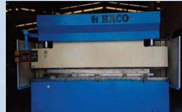
Plegadora HACO de 4000x175 Tn, equipada con control ATL 500 . Marcado CE.
