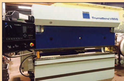
PLEGADORA CNC TRUMPF TRUMABEND V855 CNC DELEM 2.550 mm. x 85 Tm. 5 ejes controlados.
