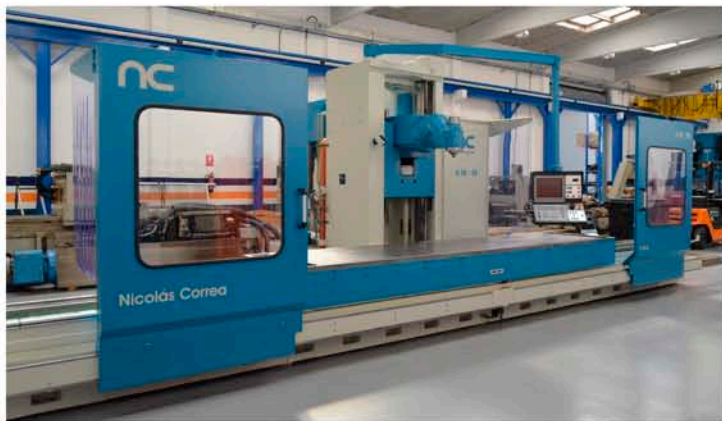
FRESADORA DE BANCADA FIJA CORREA A 30/50 HEIDENHAIN TNC 426 D. Superficie de la Mesa: 5000X1100 mm. Recorridos (X/Y/Z): 5000X1200X1000. Cabezal Giro Automático 2.5° /2.5° Amarre Hidráulico Herramientas. Año Fabricación 1998. Reconstruida 2015
