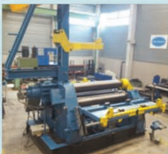
Cilindro SERTOM-CASANOVAS CN 4 rodillos Longitud 3050 x 50 mm. Precurvado 32 mm.
