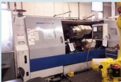
Torno DAEWWO PUMA 400 LMB cnc FANUC 21I-TB E.P. 2000 x Ø max. torneare 560 mm. Torreta motorizada.
