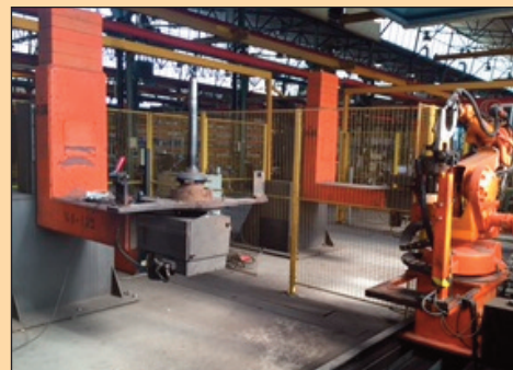
ROBOT SOLDADURA ABB IRB-2400 7 ejes controlados y 2 posicionadores de 5 Tm. de 2 ejes controlados
