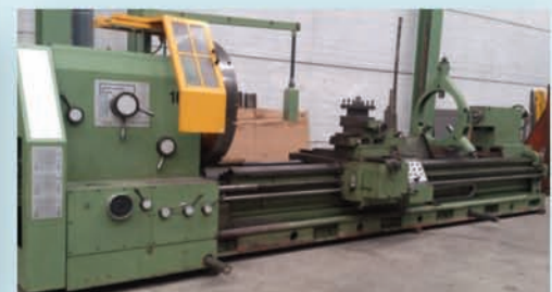
Torno GURUTZPE SUPER BT 600/4000 E.P. 4000 x Ø 1180 mm. Carro motorizado.
