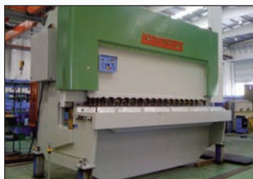
Cizalla hidráulica LOIRESAFE CH-204 de 4000 x 20 mm
