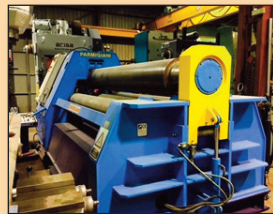
CILINDRO PARMIGIANI VBH- 3100x36/30 mm. Brazo superior, Visualizador, Soportes laterales, Dispositivo de conos.
