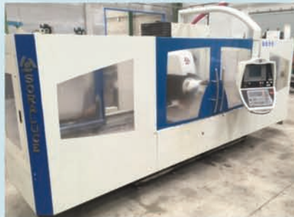
Fresadora SORALUCE TA 20 cnc HEIDENHAIN TNC 426 . Recorridos 2000X800X800 mm. Con extractor virutas + carenado
