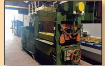
APLANADORA DE CHAPA BONAK 1400x6 mm. Regulación motorizada rodillos Rulinas de apoyo
