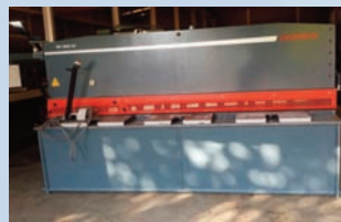
Cizalla pendular DURMA SBT 3006 NT de 3050 x 6. Marcado CE.
