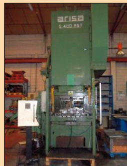
PRENSA EXCÉNTRICA ARISA 400 Tm. CNC con devanadora, aplanador y alimentador
