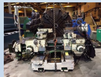
Torno frontal PONTIGGIA con plato de Ø 1750 y torneado máximo de 2.040 mm. Marcado CE.
