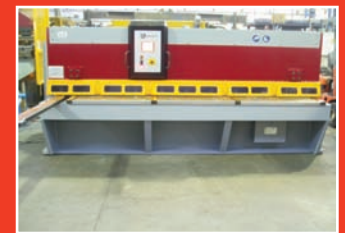
Cizalla CASANOVA, modelo VCE- 02-CN LASER, de 3000 x 6 mm
