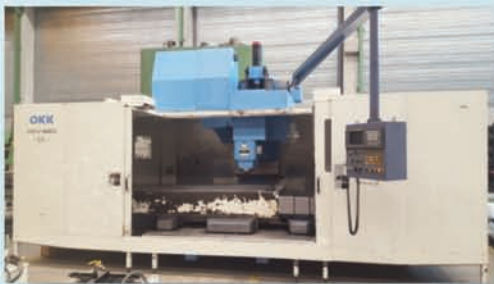
Centro OKK MCV860-UP 8000 rpm cnc FANUC 18-M Cargador 30 herramientas. Recorridos 2040x860x720 mm.
