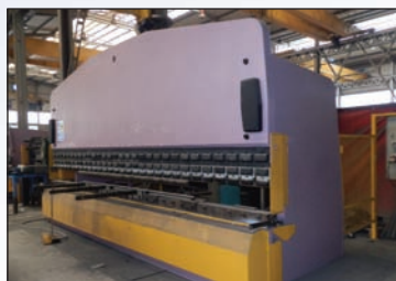
Plegadora hidráulica MEBUSA RG-406 de 6000 mm x 400 t
