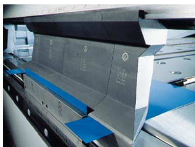
Herramientas de plegado segmentadas para flexibilidad en cualquier situación
