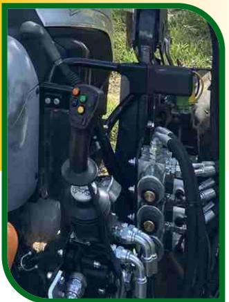
**Distributore idraulico e joystick vibrazione**
