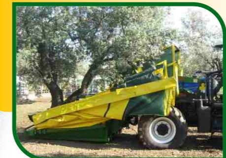
**Controllo idraulico della botola di scarico**
