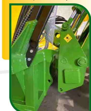
**Serbatoio e gruppo idraulico posteriore azionato dalla PTO (540 rpm)**
