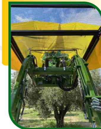
**Pinza a doppia ganascia New Generation ad alte frequenze, autocentrante, autofrenante, con doppia velocità di vibrazione**
