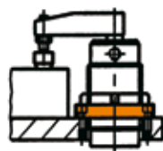
Con brida roscada y tuerca ranurada
