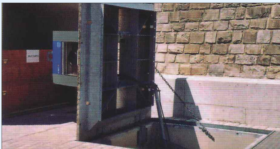
Plataforma basculante a 90° para la extracción/introducción de un contenedor
