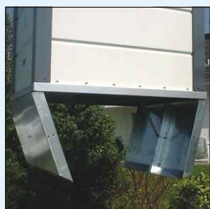
Compuerta inferior tipo bañera para la retención de líquidos
