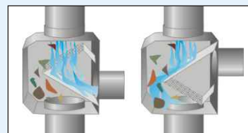
Diferente uso girando la rejilla 180° para permitir o no la entrada de agua en la cuba
