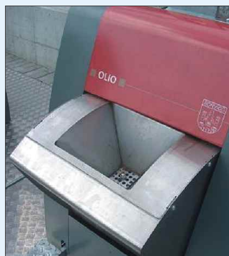
Embudo de vertido de aceite, tapa basculante
