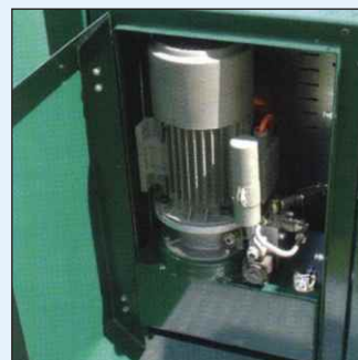
Versión 2: Sistema de elevación con motor eléctrico instalado in situ
