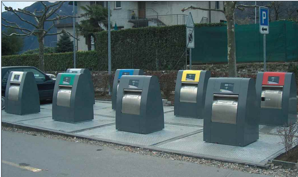
Sistema de contenedores soterrados con plataforma hidráulica
