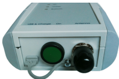
Conector Mini USB, interruptor ON/OFF y conector para antena externa de coche
