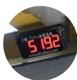
Visor electrónico de leds rojos de 200 mm.
