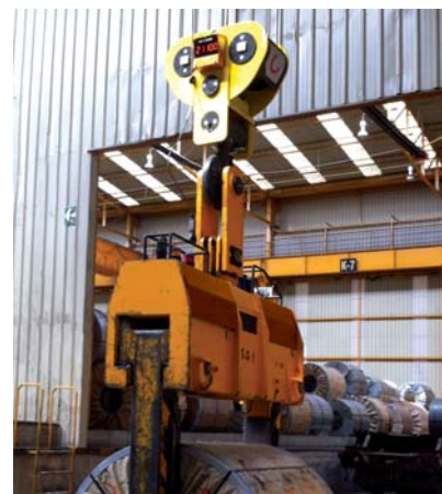
Aparejo especial con sistema de pesaje incorporado.
