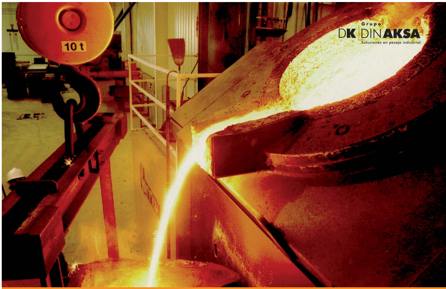
Aparejo especial con protección anticalórica para fundición.
