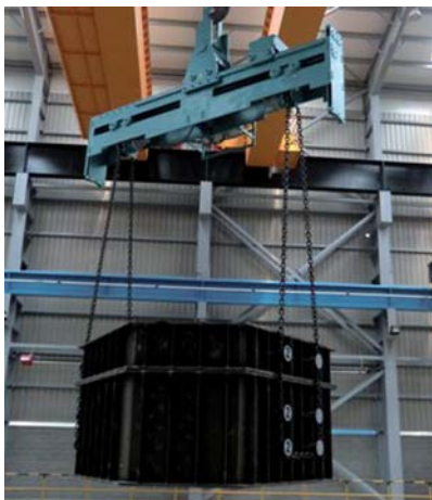
Girapiezas de 50t de capacidad con función peso-límite y transmisión de pesada a visor.
