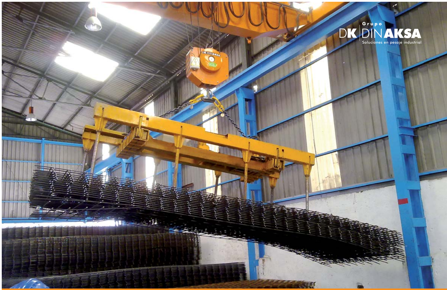
Aparejo equipado con giro motorizado y balancín especial.
