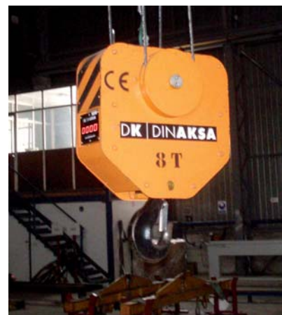
Aparejo con giro motorizado y sistema de pesaje incorporado.
