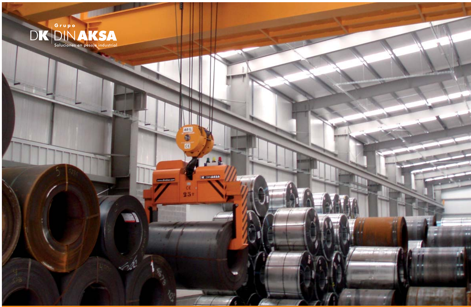
Pinza porta-bobinas con giro motorizado.
