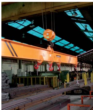
Balancín monoviga con sistema de pesaje.
