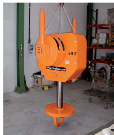
Aparejo con giro motorizado de 50t y mecanismo de enclavamiento.
