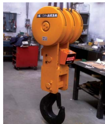
Aparejo de 3 poleas (50t) con sistema de pesaje.
