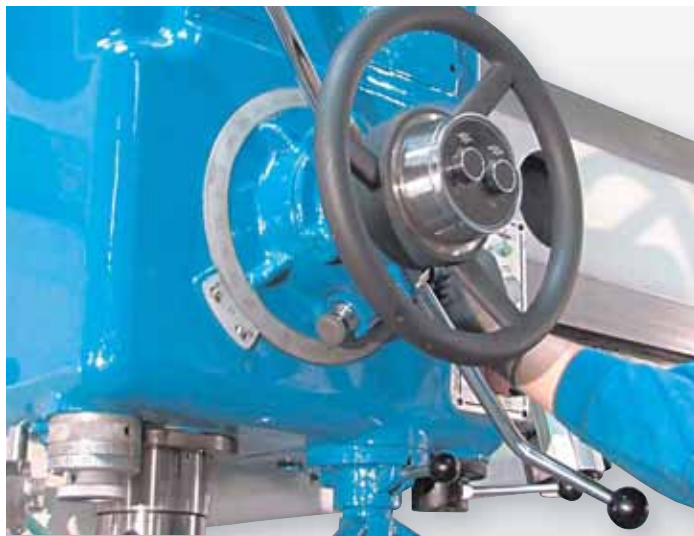
tope de profundidad con Nonius
