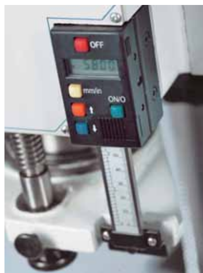
indicador digital de profundidad de taladrado
