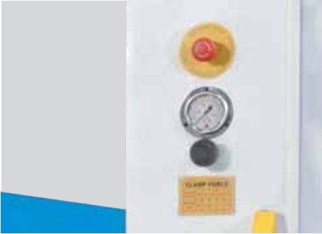
presión de sujeción del troquel superior ajustable
