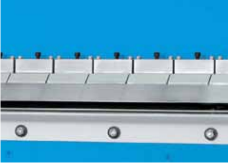
troquel superior estándar con segmentaciones de 76, 102, 127 y 152 mm
