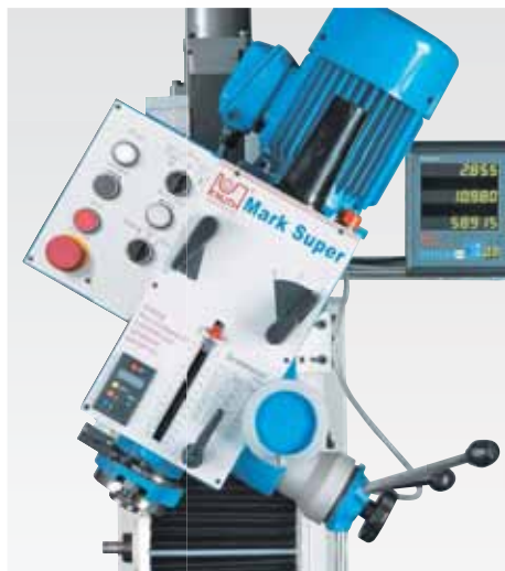
El cabezal gira \pm 45^\circ
