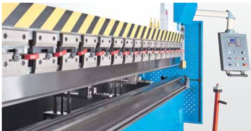
sistema de cambio rápido para troquel macho
