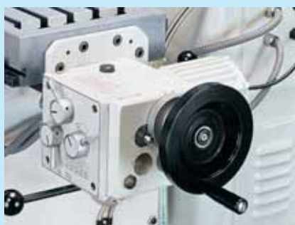
engranajes de alimentación con alimentación rápida
