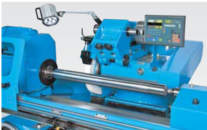
largas extensiones de rectificado de 1000 a 3000 mm
