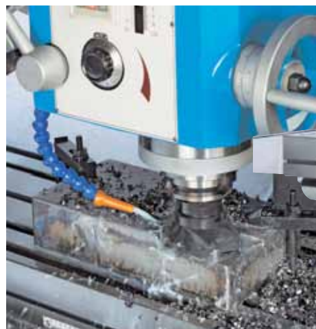
fresado frontal con cabezal de corte
