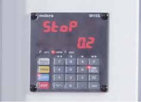
ajuste exacto del ángulo de doblado a través del control de ubicación (estándar)
