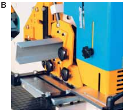
estación de acero estructural
