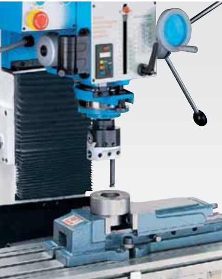
perforación y torneado al aire de diámetro interior
