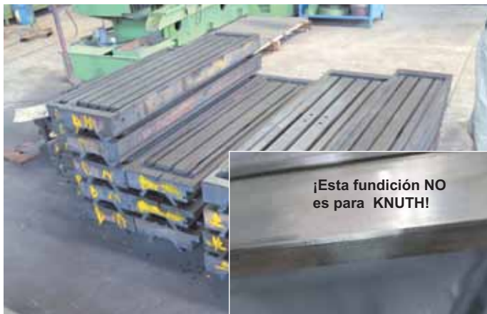
Se aceptarán solo las piezas fundidas con cero defectos que no tienen cavidades ni burbujas para la fabricación de máquina KNUTH.
