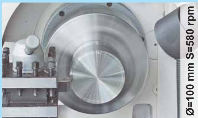
La velocidad de corte seleccionada por el operador...
