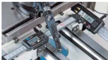
Sistema de medición de longitud digital en los ejes Z y X
