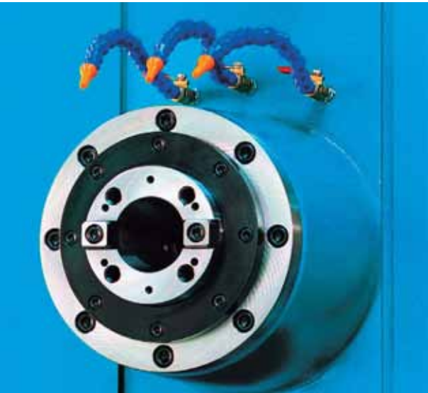
husillo de gran velocidad con enfriamiento por aceite, hasta 3000 rpm
