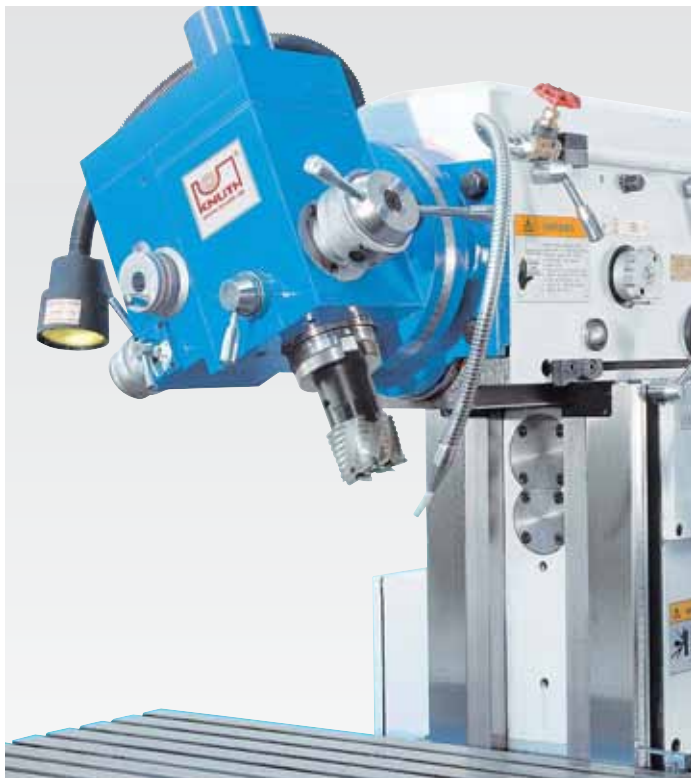
Cabezal de corte \pm 90^\circ con alimentación automática del eje hueco y recorrido del eje de 60 mm
