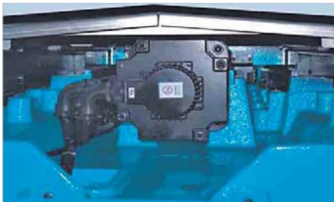
accionamiento por servomotor en los 3 ejes
