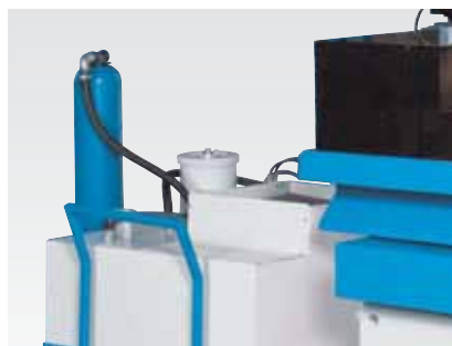
Depósito dieléctrico con sistema de filtro
