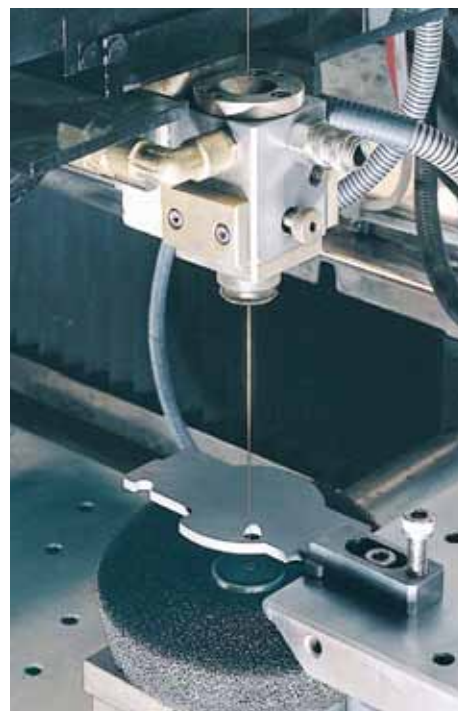
guía del cable de bajo desgaste, muy precisa
