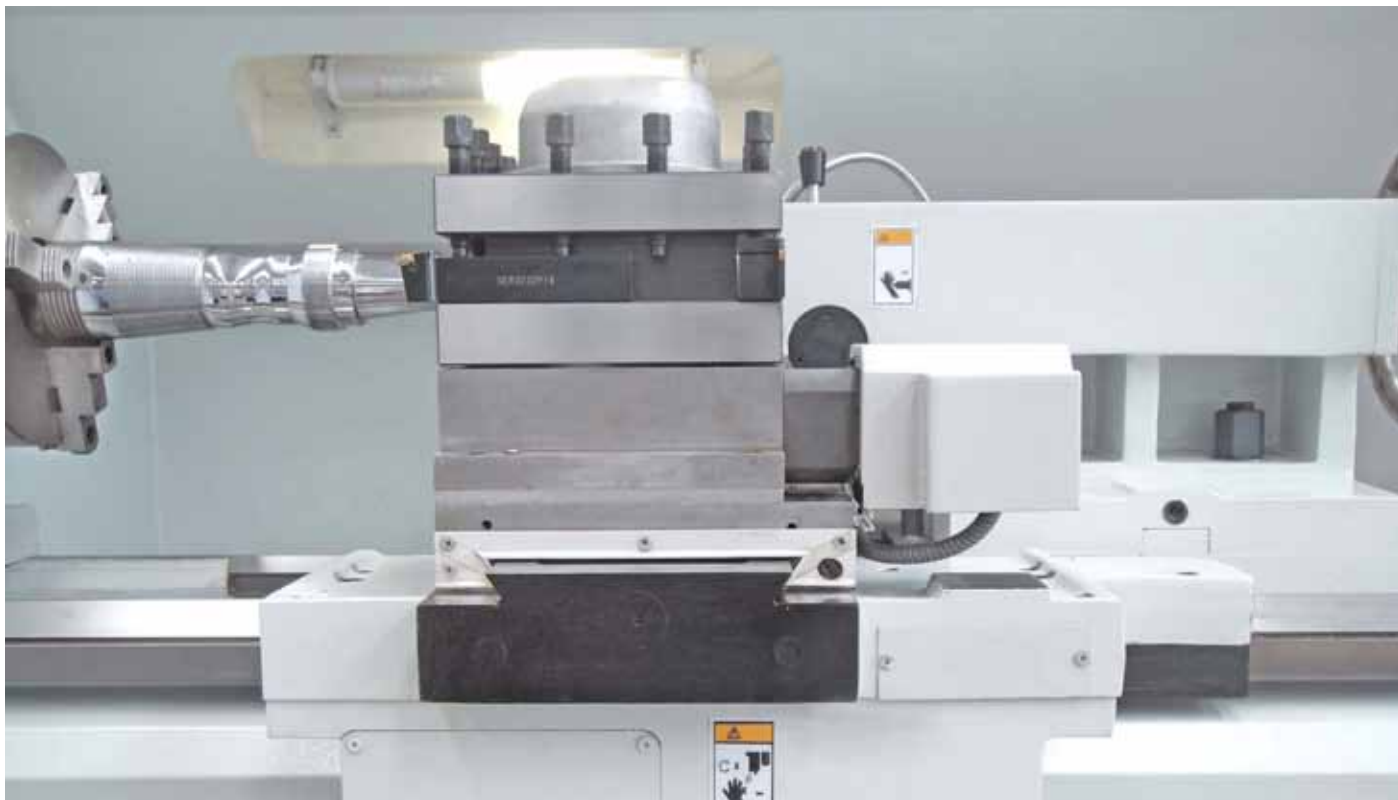
cambiador de herramientas de 4 estaciones pesado para cambios de herramientas programados
