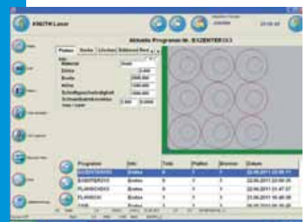
Corte las piezas con conos iniciales anidados en cuadrículas (CAD-CAM opcional)
