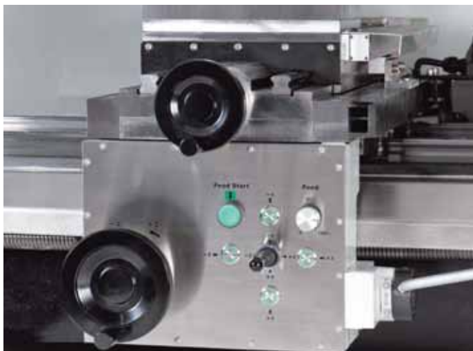
Tecnología de servomotor – incluyendo botones “Teach-in” que permiten fijar un tope límite en la posición actual
