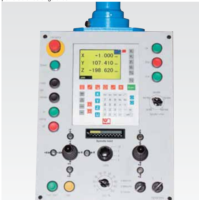
panel de control con indicador de posición X.pos Plus integrado
