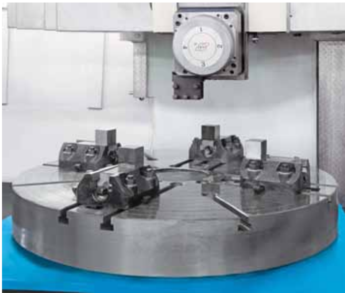
placa frontal con cambiador de herramienta de 4 estaciones
