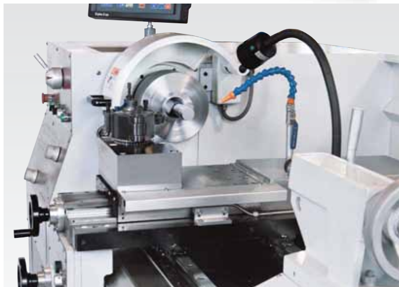
guías de riel de perfil lineal en Z e X
