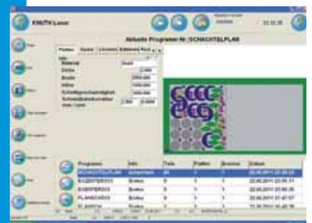
anidamiento de contornos en el resto de la cuadrícula (exceso) y separación del material de exceso de la placa (opcional)
