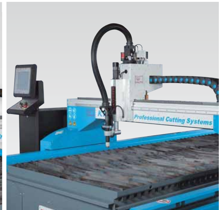
Cortador Hypertherm Calor con control de altura del soplete
