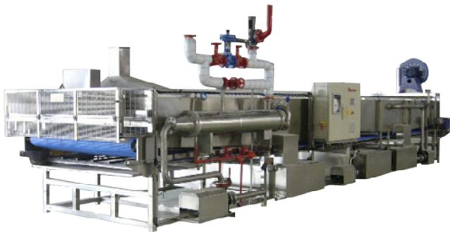
El mejor túnel de pasteurizado y enfriamiento de envases mediante aspersión de duchas de agua a presión. Posee sistema de calentamiento a través de intercambiador de calor tubular y enfriamiento a través de intercambiador de placas o agua de torre directa. Las dimensiones del túnel se definen en función de la producción, del tamaño del envase y de los tiempos de tratamiento térmico.
