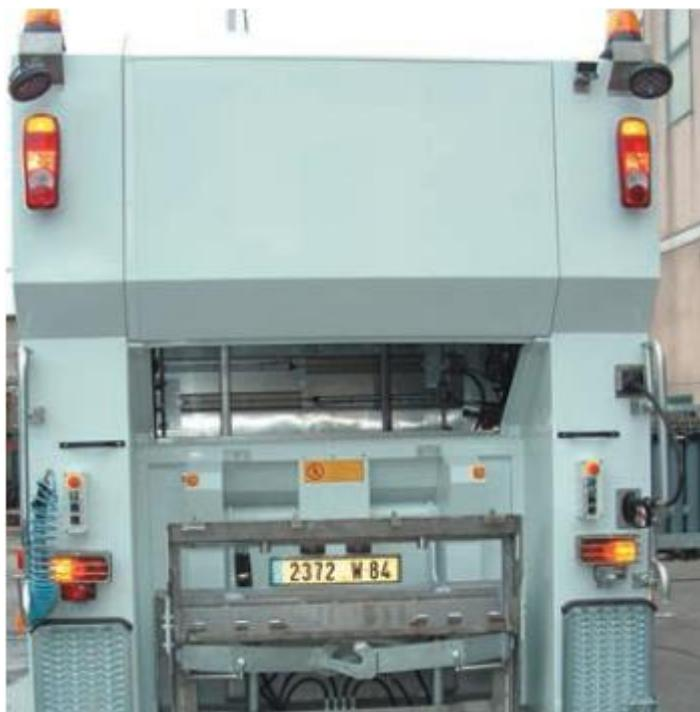
El diseño particular de la cámara de lavado, nos permite una carga rápida del contenedor, dejando un espacio sin precedentes para el posicionamiento perfecto de la tapa del mismo en el interior de la cámara de lavado.
