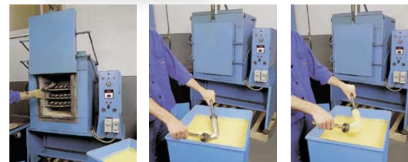
REVESTIMIENTO PLASTICO ANTICORROSIVO
