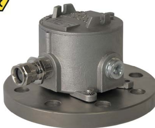
Caja Ex d IIC T6 con prensaestopas ATEX, suministrado sólo bajo demanda
