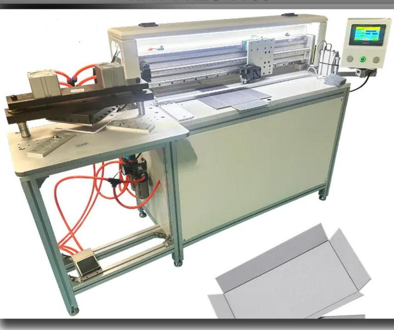
Máquina para realizar muestras de cartón de cajas rígidas con fresado en "V".
