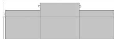
Cajón doble, solape uno tras otro 150 mm ancho x 250 mm alto.
