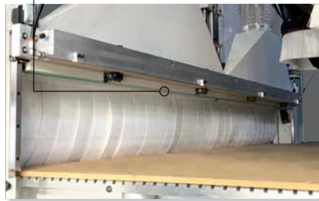
Empujador salida piezas con grupo sopladores para la limpieza del tablero
