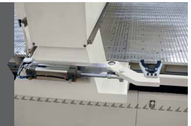
Almacén cambio herramientas "Pick-up" Con posicionamiento neumático sobre el puente máquina. Equipamiento ideal para trabajos de tableros en péndulo. pratix s
