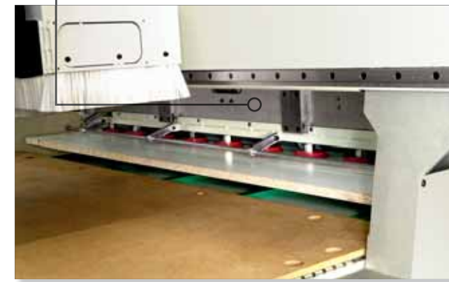
Grupo carga piezas con ventosas y grupo sopladores para la limpieza del tablero
