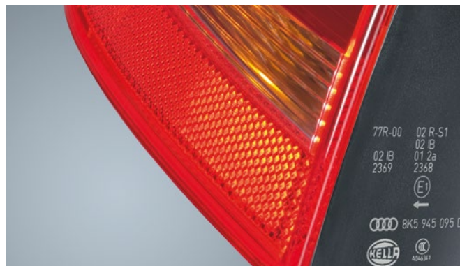
Inscripción de alto contraste de logotipos y datos de fabricación.
