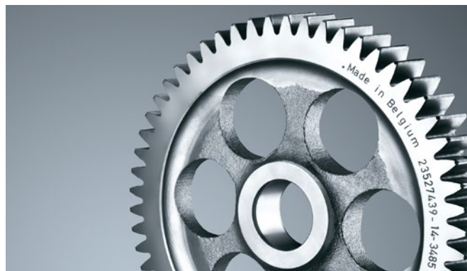
Marcado permanente de un número de serie en una pieza de engranaje.
