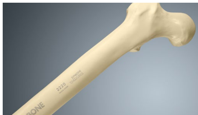
Marcado sobre un hueso artificial de poliuretano.
