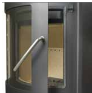
Cristal vitrocerámico de 5 mm de espesor resistente a temperaturas de entre 700-1200°C. Manecilla de acero inoxidable muy cómoda de maniobrar y perfectamente integrada.
