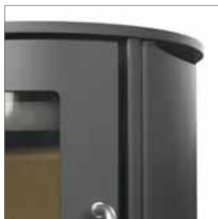
La estructura de doble pared, fabricada en acero de 5 mm de espesor, permite una constante circulación del aire. El aire frío que entra por la parte inferior se calienta al pasar alrededor de la cámara de combustión y sale por el orificio situado en la parte superior de la estufa, por donde el calor se distribuye de forma agradable dentro del hogar.
