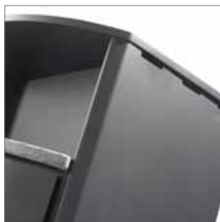
La estructura de doble pared, fabricada en acero de 5 mm de espesor, permite una constante circulación del aire. El aire frío que entra por la parte inferior se calienta al pasar alrededor de la cámara de combustión y sale por los orificios situados en la parte superior de la estufa, por donde el calor se distribuye de forma agradable dentro del hogar.
