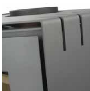
La estructura de doble pared, fabricada en acero de 4 mm de espesor, permite una constante circulación del aire. El aire frío que entra por la parte inferior se calienta al pasar alrededor de la cámara de combustión y sale por los orificios situados en la parte superior de la estufa, por donde el calor se distribuye de una forma agradable dentro del hogar.
