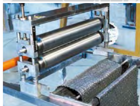
Figura 18 Impregnación a máquina de MAPEWRAP C
