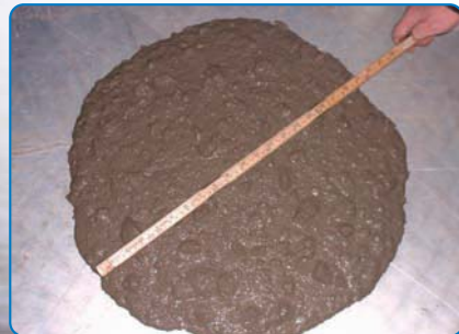
Diámetro medido después de aprox. 3 minutos. El diámetro debería ser mayor de 550 mm
