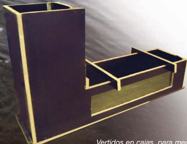
Vertidos en cajas, para medir el flujo en agua. El fondo de la caja está lleno de agua.
