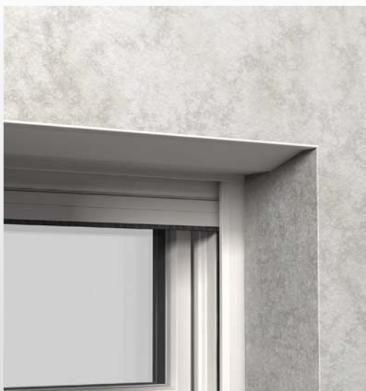
Ejecución de cajón exterior no visible con canto y soporte para enlucido. En el interior la ampliación puede ser aislada y revocada adicionalmente.
