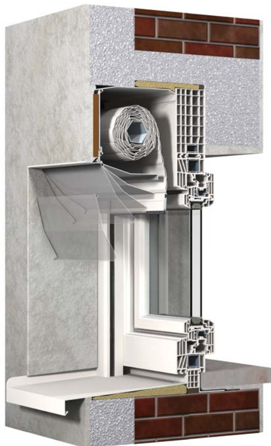
Ejecución de cajón exterior no visible con canto y soporte para enlucido. En el interior la ampliación puede ser aislada y revocada adicionalmente.
