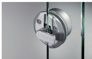
Construcción a salvo de manipulaciones. La construcción especial con superficie moleteada impide que la carcasa de la cerradura pueda girarse en el vidrio, aportando más seguridad al sistema. (Ver esquema B)
