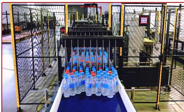
Estructura lateral y barandillas de formación de carriles construidas en acero inoxidable AISI304; para transportar el producto, se utiliza una banda modular motorizada, tipo "Intralox", controlada por un variador de velocidad electrónico.
