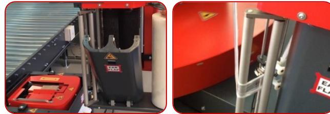
**Kit cordón:** este modo permite realizar un cordón programable a varias alturas de la carga, reforzando y estabilizando la carga. Indicado para cargas inestables fragmentadas o por capas.
