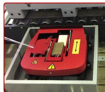
Además, realiza un cordón al film en el proceso final, permitiendo así la soldadura de cualquier tipo de film (estirable, macroperforado, etc...) y micraje, a cualquier tipo de carga, evitando colas iniciales y finales de film.
