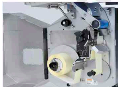
Impresora inferior con rollo de etiquetas hasta 210 mm en carcasa a prueba de salpicaduras
