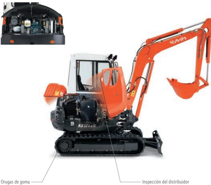
En la serie KX-3 la concepción de las orugas de goma asegura una mejor duración de vida y estabilidad durante la traslación. La forma de los tacos, que tienen un mayor contacto con el suelo, permite menos vibraciones durante la traslación v una mejor estabilidad de la máquina así como los nuevos rodillos con doble punto de apoyo.
