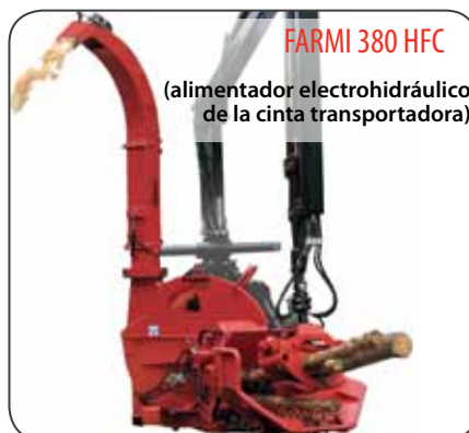
FARMÍ 380: Disco de rotor doble, cortador estándar u opcional, alimentador de cinta
