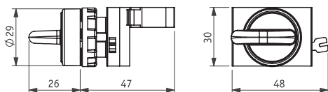
Dimensiones del montaje: diámetro 22.4 ±0.2 mm
