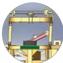
enganche de 3 puntos con desplazamiento lateral, paralelogramo
