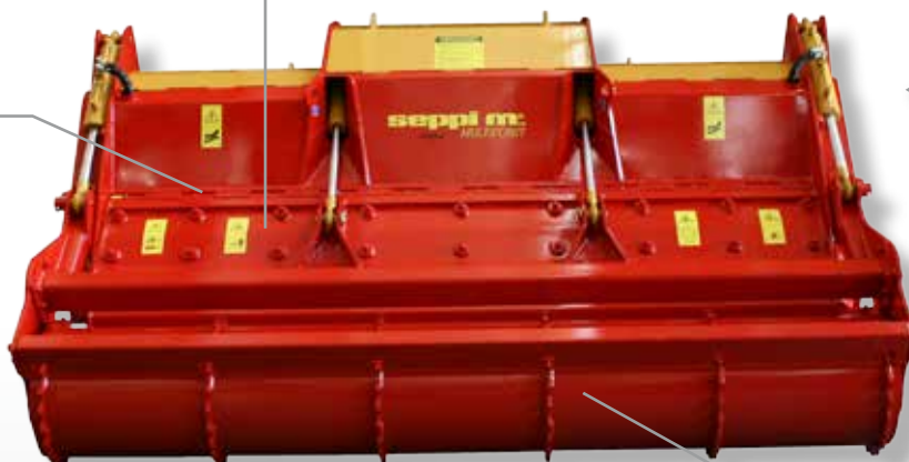
rodillo compactador del suelo en dos posiciones; levantado sirve como bajador de ramas
