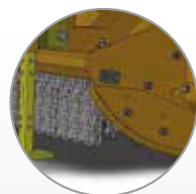
patines estrechos para penetrar fácilmente el suelo
