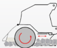
barra retenedora regulable para controlar el grado de triturado
