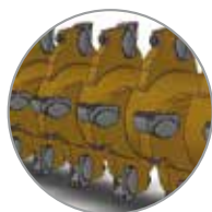
rotor de martillos fijos con placas de metal duro
