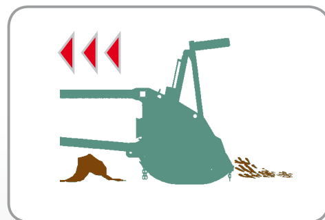
fase 3a: triturar fino el material talado pasando sobre él en dirección opuesta y con el capó cerrado
