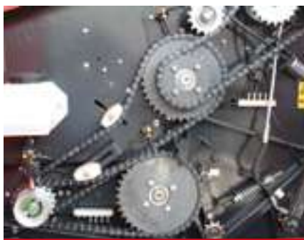
Lubrificazione automatica delle catene. / Automatic lubricating system. / Lubricación automática de las cadenas. / Graissage des chaînes automatiques.
