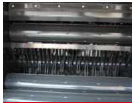
Camera di compressione a 16 rulli. / Baling chamber with 16 rollers. / Cámara de compresión con 16 rodillos. / Chambre de compression à 16 rouleaux.
