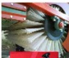
El cepillo (accionamiento mediante cadena y piñones) está compuesto de 24 hilera de PVC indeformable que respeta la estructura de las fibras sintéticas que componen el césped artificial
