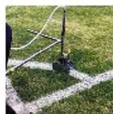
Sencillo sistema de trazado del "corner" de serie en los modelos **MARKER** y **ELEKTRO**
