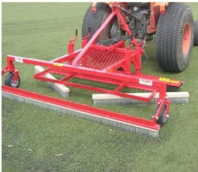
Trabaja corrigiendo la forma del césped artificial, nivelándolo y descompactando su superficie de una sola pasada, evitando dejar cualquier rastro o marcas sobre el terreno y otorgándole más flexibilidad
