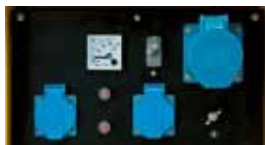
Voltímetro para controlar la tensión
