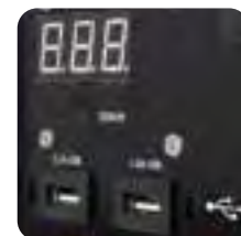
2 SALIDAS USB 5v 2.1 A (total) PANTALLA LED DIGITAL Muestra el estado de carga de la batería (voltaje)
