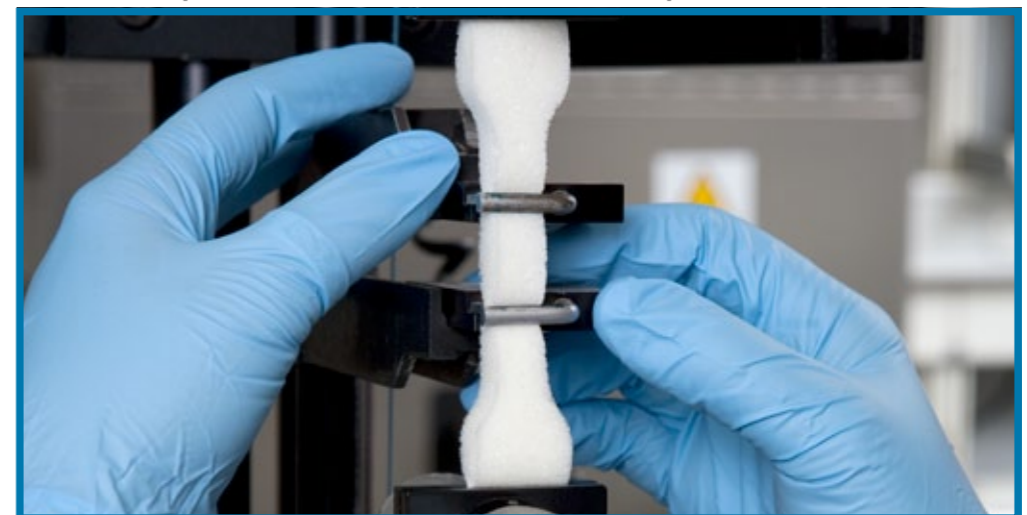
Detalle máquina INSTRON: resistencia de la espuma a la tracción
