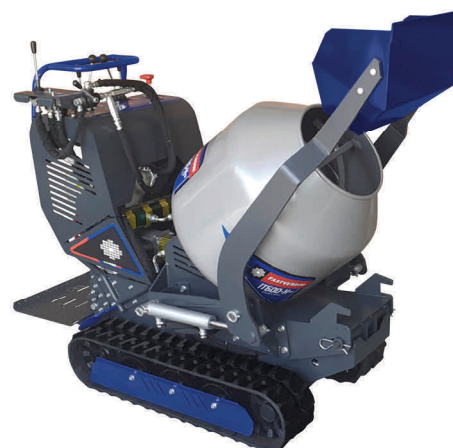
IT600HBP con hormigonera y pala autocargable
