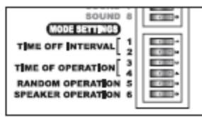
Los siguientes seis interruptores determinan el modo de operación: el intervalo de tiempo entre sonidos, cuándo funcionará el equipo (24 horas, sólo día o sólo noche), si el equipo funcionará en modo normal o aleatorio y si los altavoces operarán en secuencia o de modo simultáneo.
