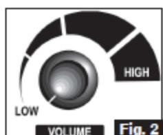
**IMPORTANTE:** Asegúrese de que el interruptor está en la posición **OFF** y el control de volumen está ajustado al mínimo (**LOW**) al encender el aparato (nivel de volumen a la izquierda como se muestra en la figura. 1).
